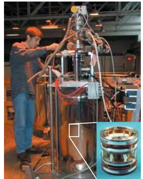
Mit Hilfe einer Penning-Falle (kleines Bild) vermisst die Gruppe um Dr. Klaus Blaum (links) Isotopenmassen. Dabei kommen Magnetfelder zum Einsatz, die rund viermal so stark sind wie die von Elektromagneten, die auf Schrottplätzen Autos herumwuchten. (Bild: ISOLTRAP Kollaboration, Kontaktperson: Dr. Klaus Blaum, Universität Mainz, Institut für Physik, 55099 Mainz)
